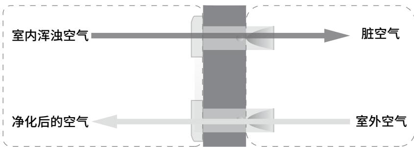
分布式新风系统是一种无管道新风系统，只需在外墙开孔，安装便捷，因此适用于在要求尽可能减少施工的新建及装修改造项目中。热交换器热回收率高，可保证设备通风换气的同时，温度无明显波动。
